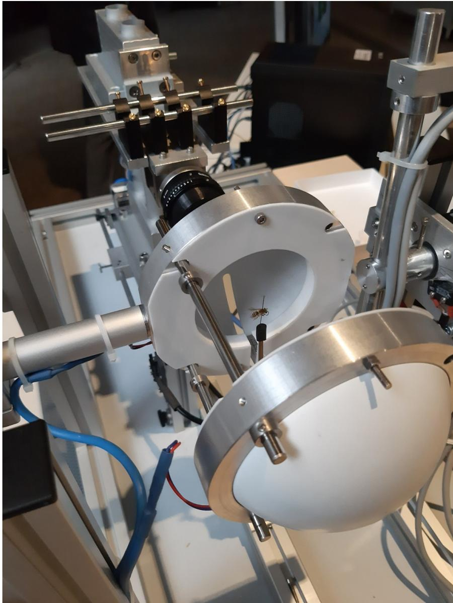
*Figura 1: Equipamento de digitalização tridimensional. O objeto colocado ao centro da câmara é rotacionado e são tiradas cerca de 6 mil fotos em diferentes ângulos e com diferentes níveis de zoom. Todo o processo fotográfico tem duração de 6h para cada espécime.*
