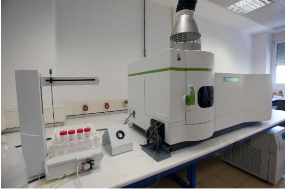
À esquerda, espectrômetro ICP-MS e amostrador automático, utilizado para análises de elementos traço em rocha total. À direita, microsonda eletrônica CAMECA SX100 que será utilizada para análises de química mineral e realização de mapas composicionais (fotos retiradas do website do laboratório https://cic.ugr.es/ ).
