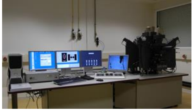
À esquerda, espectrômetro ICP-MS e amostrador automático, utilizado para análises de elementos traço em rocha total. À direita, microsonda eletrônica CAMECA SX100 que será utilizada para análises de química mineral e realização de mapas composicionais (fotos retiradas do website do laboratório https://cic.ugr.es/ ).
